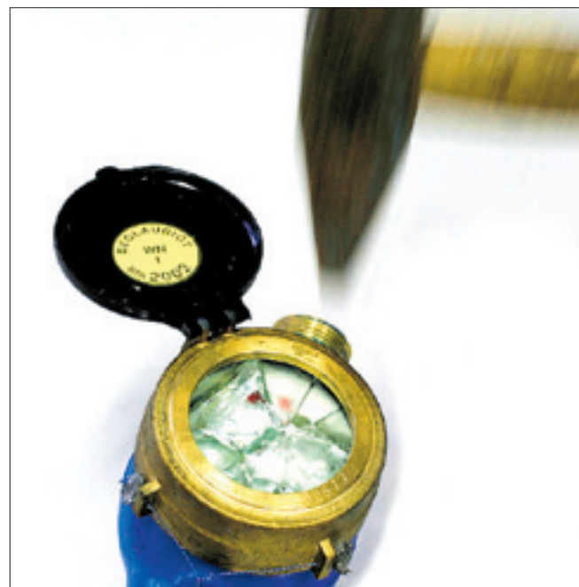
Hammerbart schlägt der Frost auf ungeschützte Zähler.
