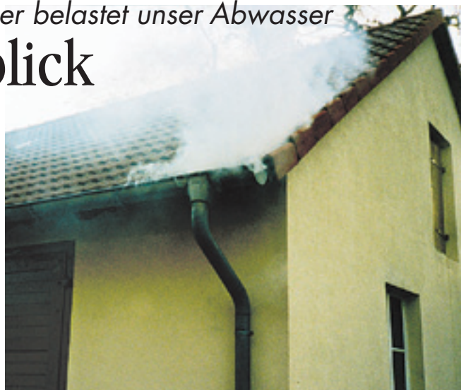
Ertappt. Der Nebel bringt den Nachweis für eine unerlaubte Einleitung von Regenwasser in die Kanalisation.
