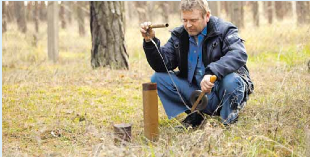
Sieht unspektakulär aus und ist doch Teil des anspruchsvollen Grundwassermonitorings: TAZV-Mitarbeiter Kurt Schulze beim Erfassen eines Pegelstandes am Wasserwerk Pohlitz.
