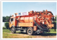
Mithilfe von Entsorgungsfahrzeugen werden Fäkalien im Verbandsgebiet dezentral entsorgt.
